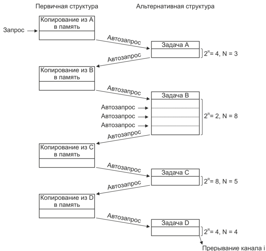
Рисунок 8.4 – Пример функционирования контроллера в режиме «разборка-сборка»
