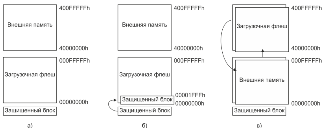
Рисунок 7.10 – Процесс мапирования при загрузке микроконтроллера (указанные диапазоны адресов соответствуют реальным объемам памяти микроконтроллера).
